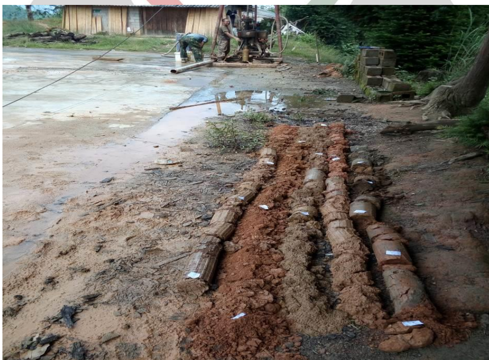
图 4：帕掌河小学地质勘探现场岩心样品
